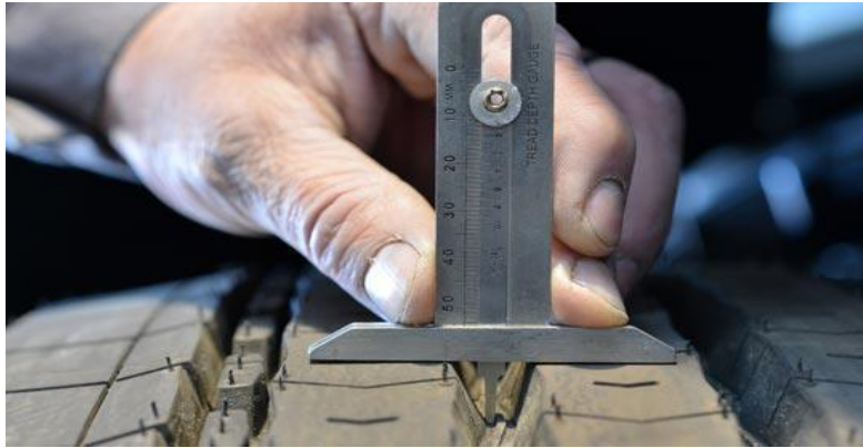
Figure 2.9 Jauge de mesure de sculpture des pneus
